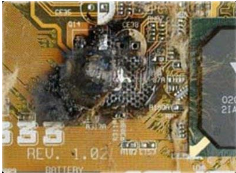
Condensator verbrand door 2kHz-150kHz emissies
