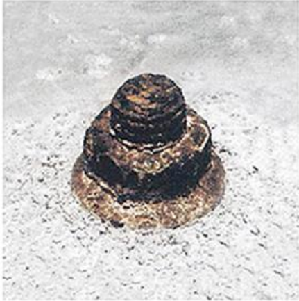
Stalen bout en moer, met zink-/ijzercoating. Geheel verroest. Aluminium: er hebben zich 0,43 mm diepe putten gevormd.
