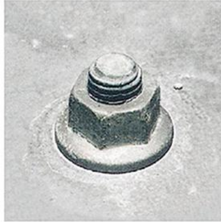
Stalen bout en moer, met Dacrolit-coating. Geen roestvorming. Aluminium: geen putcorrosie.
