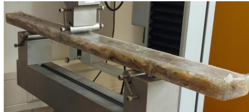
3-punts buigtest modelproefstuk
