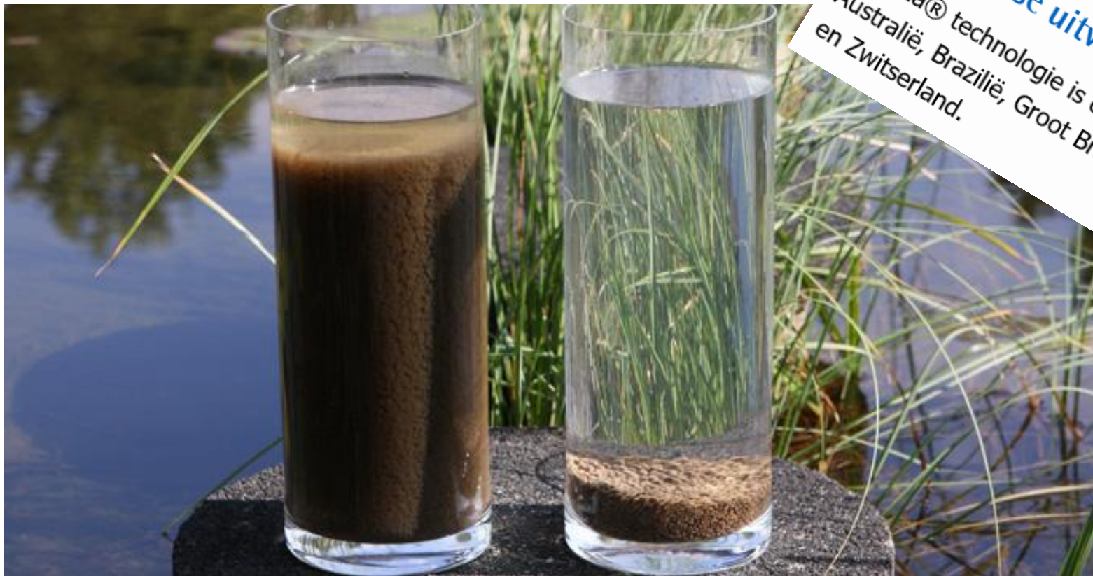
Traditioneel bezinkingsproces versus bezinking bij Nereda®-technologie
