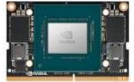
Nvidia tegra SoCs 275 TOPS 2048 AI cores
